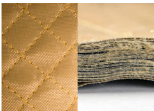
Gewebe-Schutzpaket als Beispiel für Weichballistik
